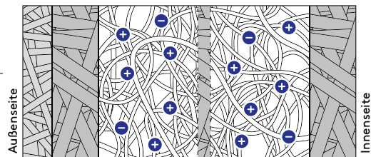
Das Filtervlies in der Mitte (sog. Meltblown) hat eine elektrostatische Ladung zur Filterung feinsten Aerosole.
